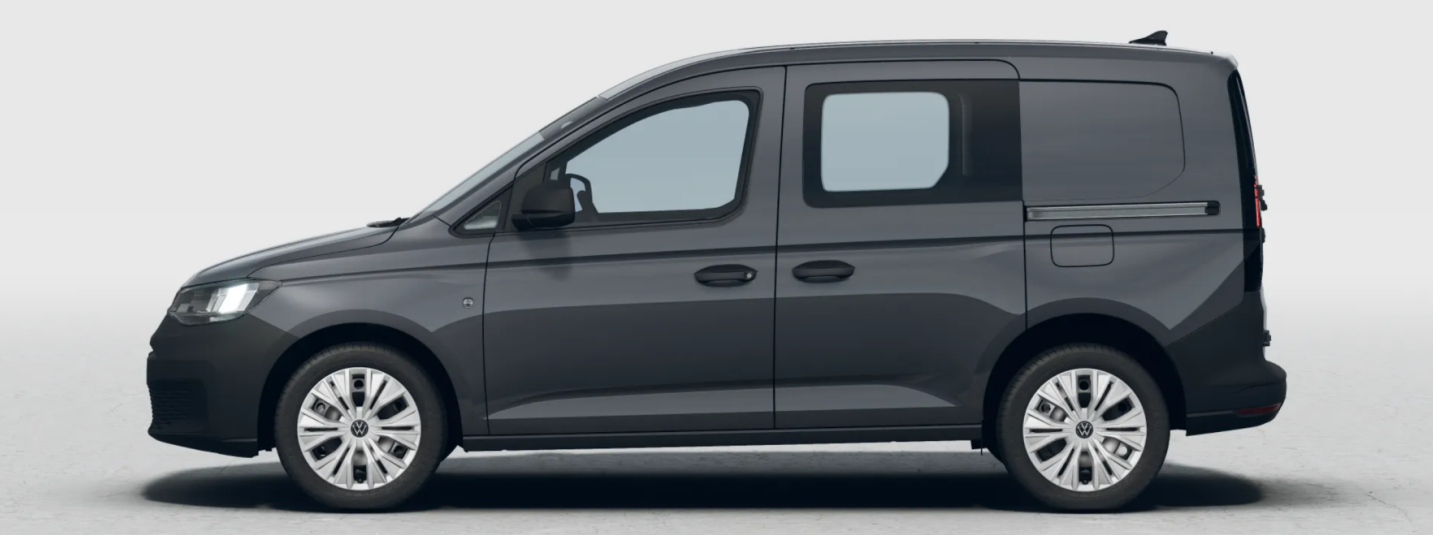
z.B. Caddy Flexible 5-Sitzer 1,5 l TSI EU6 85 kW Getriebe: 6- Gang-Schaltgetriebe Radstand: 2755 mm KR
