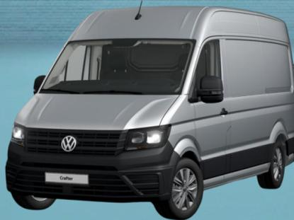
z.B. Crafter 35 Kasten Motor: 2,0 l TDI EU6-EC SCR 103 kW Getriebe: Frontantrieb 6-Gang-Schaltgetriebe Radstand: 3640 mm MR
