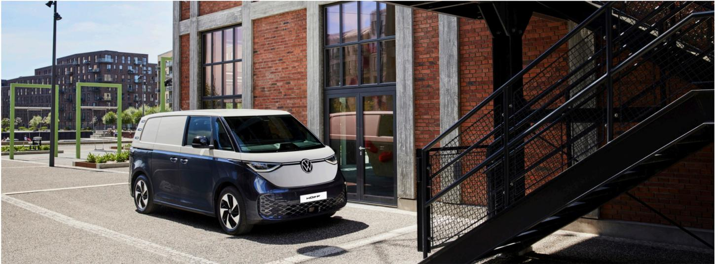
z.B. ID. Buzz Cargo Pro Motor: 210 kW (286 PS) 79 kWh Getriebe: 1-Gang-Automatikgetriebe Radstand: 2989 mm
