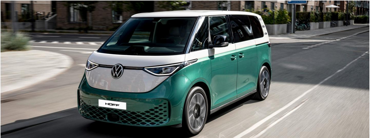
**z.B. ID. Buzz "ENERGY" kurzer Radstand 210 kW (286 PS) 79 kWh Getriebe: 1-Gang-Automatikgetriebe Radstand: 2989 mm KR**
