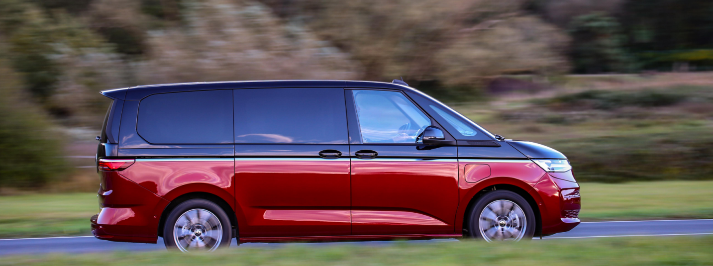
z.B. Multivan 1,5 l eHybrid OPF 4MOTION 130 kW 100 kW 19,7 kWh Getriebe: 6-Gang-Doppelkupplungsgetriebe Radstand: 3124 mm KÜ kurzer Überhang
